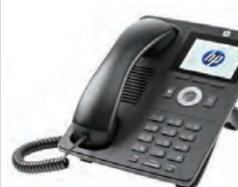
HP 4110 IP Phoneは、Power over Ethernet (PoE) 接続に対応しているほか、オプションの電源アダプターから給電することも可能です。取り付けが簡単な壁面マウント機能も備えています。HP 4110 IP Phoneは、「ホットデスクing(デスクの共用)」用の電話機として使用できます。電話機でPIN番号を入力してMicrosoft Lyncユーザーアカウントにログインすれば、ボイスメール、個人の連絡先、カスタマイズしたユーザープロフィールなどにアクセスできます。
