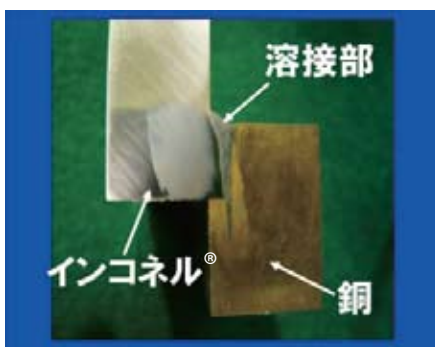
インコネル®と銅の溶接例
